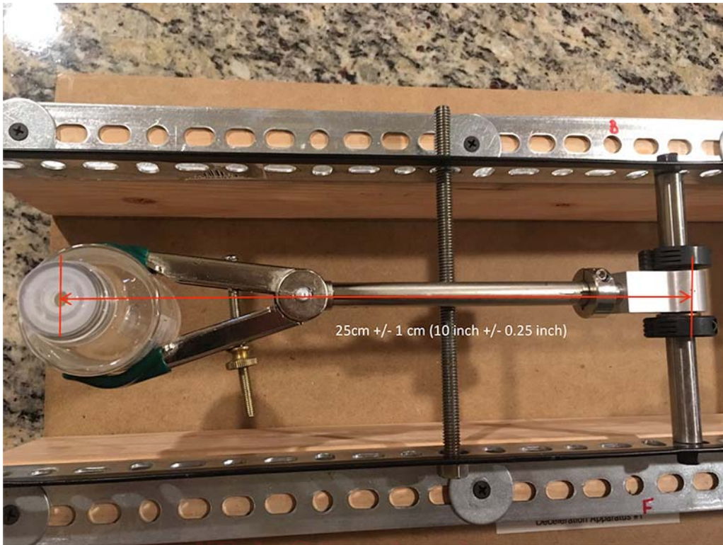
FIG. 2 Pendulum Arm Dimensions
