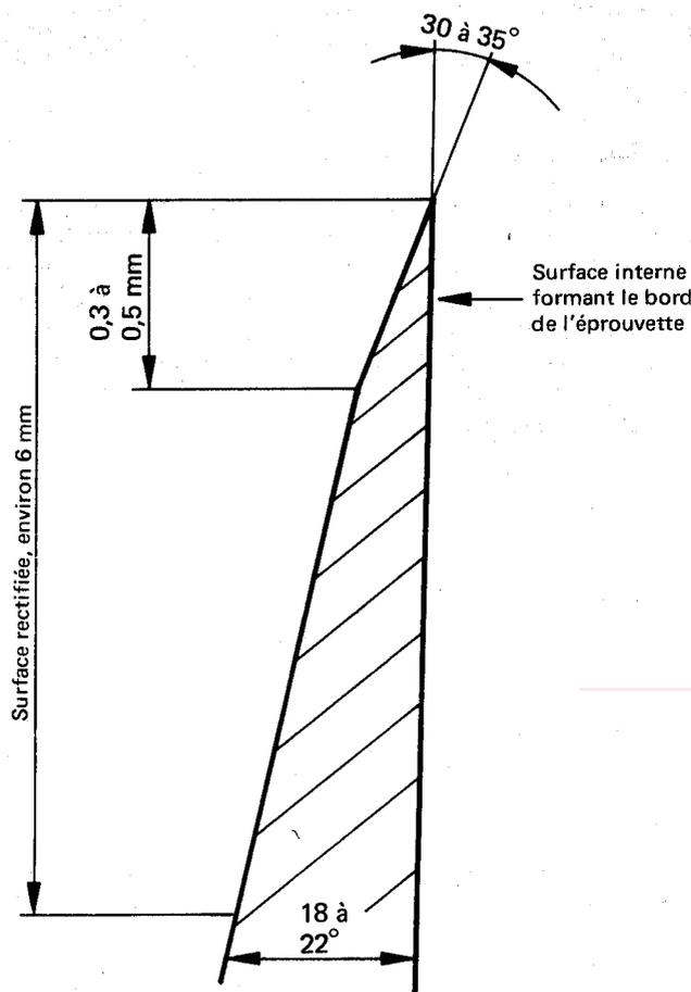
FIGURE — Tranchant de la lame
