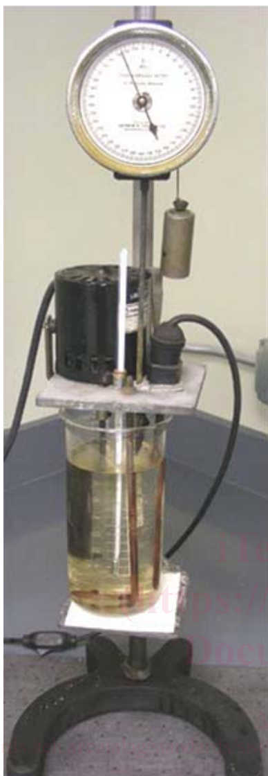
FIG. 1 Shrinkage Meter Apparatus (“Shrinkometer”)
