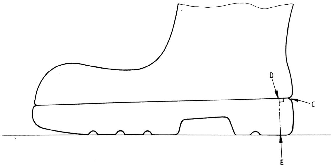
Figure A.1 — Mesurage de l'épaisseur du talon
