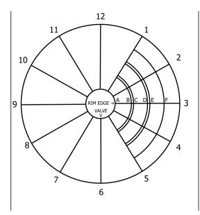
EXP. TIRE NO. MACHINE POSITION NO. COLORED SIDEWALL SIDE MOUNTED ON MACHINE FACING OUTSIDE \_ FACING INSIDE SIDEWALL CONFIGURATION DETAILS, DIMENSIONS\* A. RIM EDGE B. LOWER COVER STRIP RECESS EDGE C. LOWER COLORED SIDEWALL EDGE D. UPPER COLORED SIDEWALL EDGE E. UPPER COVER STRIP RECESS EDGE F. UPPER COVER STRIP EDGE (A-B) 12 mm (B-C) 0.45 mm (C-D) 22 mm
