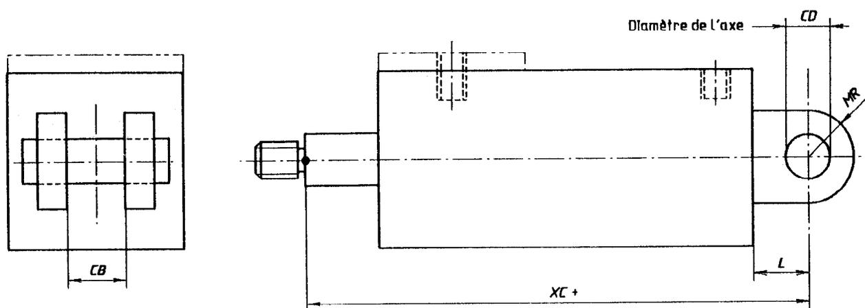
Figure 4 — MP1 — Fixation par chape arrière
