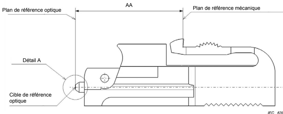
NOTE Affiché sans obturateur pour permettre une meilleure visibilité du dispositif (voir Figure 2b pour les détails de l'obturateur).
