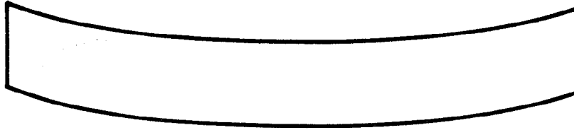
Déformation inacceptable (Centre plus bas que l'extrémité.)
