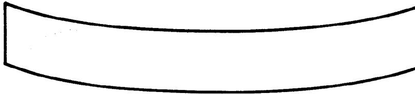
Déformation inacceptable (Centre plus bas que l'extrémité.)
