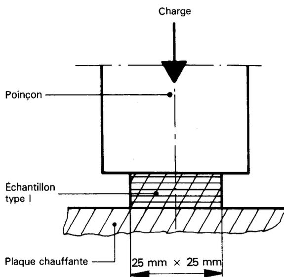
Figure 1 — Matériau de friction pour plaquettes de freins à disques
