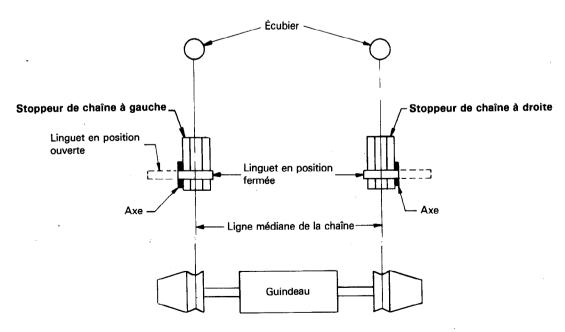
NOTE — La figure 1 est donnée uniquement à titre indicatif. Elle n'implique pas que le linguet soit le seul moyen de blocage utilisable; d'autres moyens, tels que ceux des stoppeurs à vis par exemple, peuvent être utilisés.
