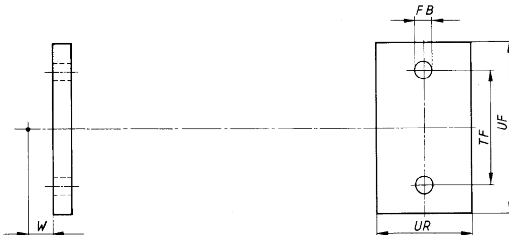
Figure 2 – Fixation par bride avant rectangulaire à deux trous (MF8)
