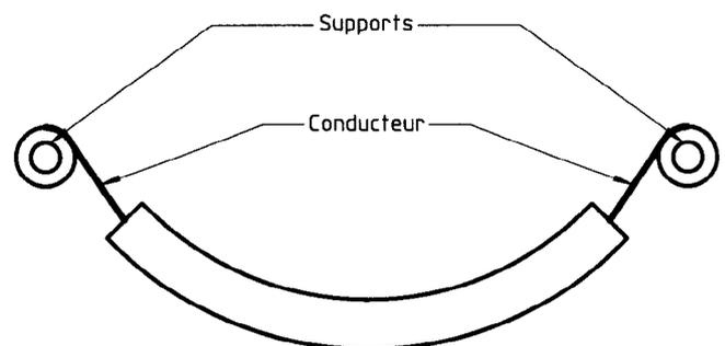
Figure 6 — Fixation des échantillons d'essai
