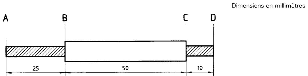
Figure 3 — Échantillon d'essai d'adhérence de la couche d'isolation sur le conducteur
