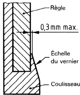
Figure 3 — Coulisseau avec vernier superposé
