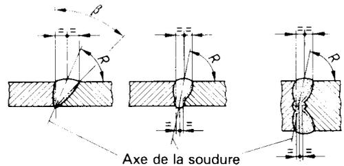
Figure 4 — Exemples de rotation, R, des soudures bout à bout asymétriques sur surface de pièce horizontale
