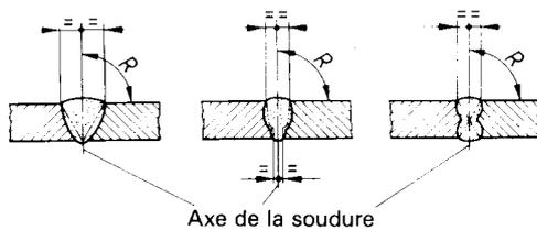
Figure 3 — Exemples de rotation ( $R = 90^\circ$ ) des soudures bout à bout symétriques sur surface de pièce horizontale
