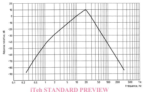
NOTE — Il est possible de réaliser physiquement la pondération G, avec une très bonne approximation, avec des réseaux inductance/résistance/capacité simples. (Standards.iten.al)
