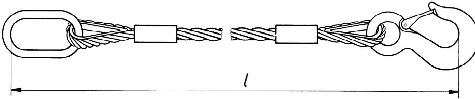
Figure 2 — Longueur d'une élingue à un brin avec deux accessoires d'extrémité
