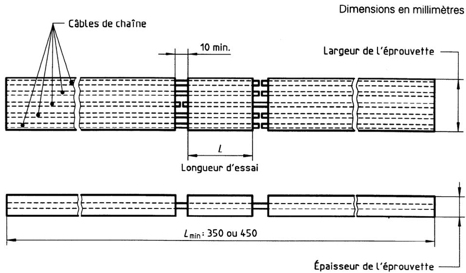
**Figure 1 — Éprouvette pour essai d'adhérence du câble d'acier dans son enrobage**
