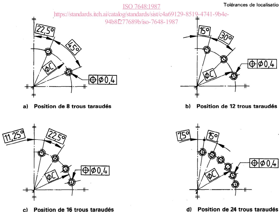
Figure 2 – Positions des trous taraudés pour vis ou boulons
