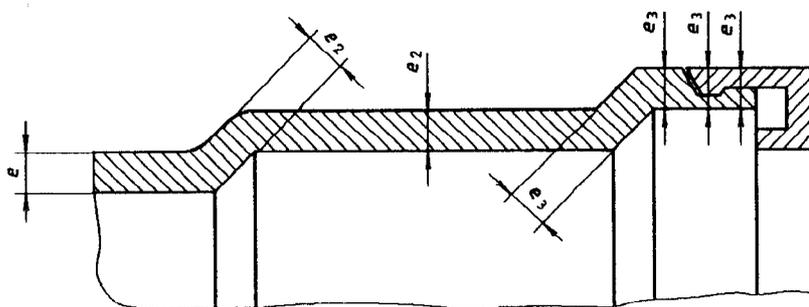
Figure 3 — Exemple de collet de blocage
