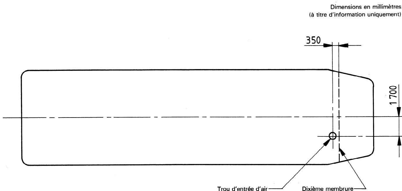
Figure 1 — Disposition du trou d'entrée d'air sur barge de la série 3 embarcable à bord d'un navire
