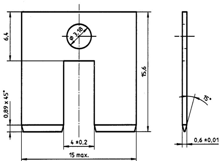
Figure 2 — Shunt d'essai
