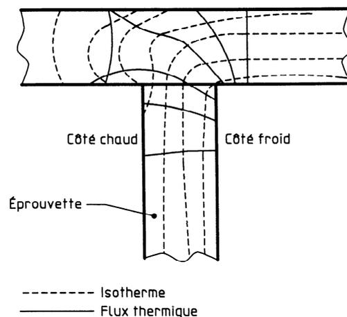
Figure 3 — Flux thermique dans l'éprouvette et armature
