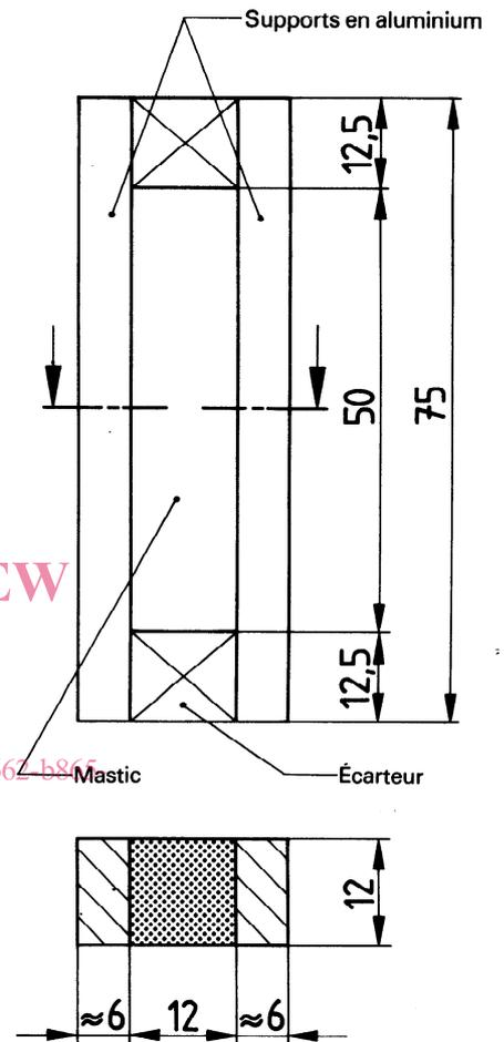
Figure 2 — Éprouvette avec supports en aluminium
