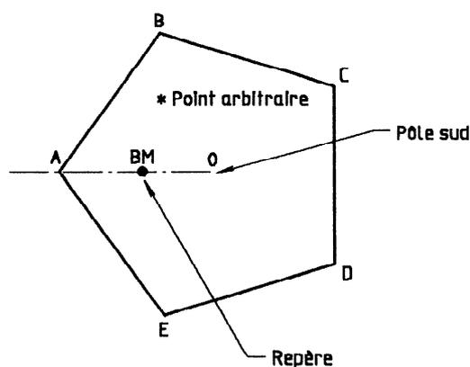
Figure 3 — Position des repères et mire de visée
