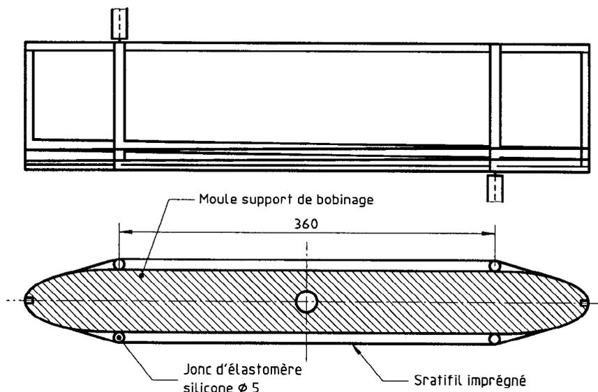
Figure 4 — Moule support de bobinage
