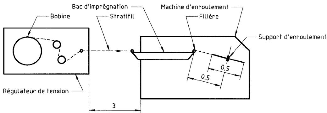
Figure 1 — Schéma d'un dispositif d'imprégnation
