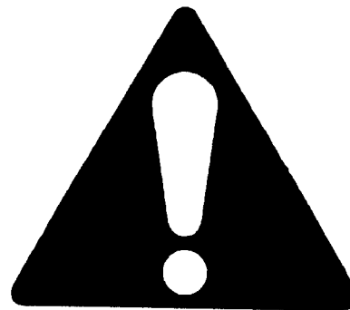
Figure 5 — Symbole de mise en garde pour les signaux de sécurité comportant l'un des termes de mise en garde
