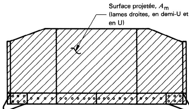
Figure 2 – Surface projetée de la lame
