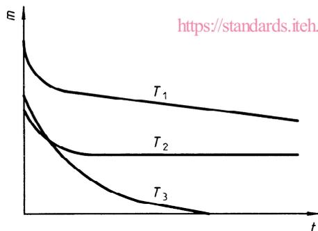
Courbe  $T_1$ : température trop basse: long temps de dégazage
