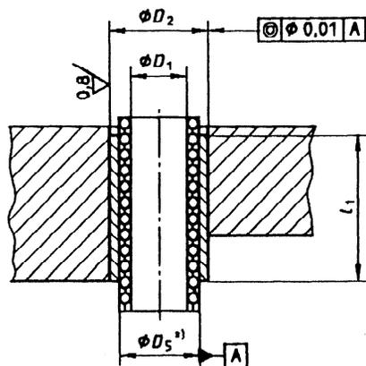
\*) Le constructeur doit déterminer le diamètre intérieur  $D_5$  de la bague, de tolérance de fabrication M5. Ce diamètre est destiné à être repris afin d'assurer la précontrainte correcte entre la colonne et la bague, déterminée par le constructeur. Cette reprise doit s'effectuer par rodage avec une rugosité de surface  $R_a = 0,05 \mu\text{m}$ , et ce diamètre doit servir de référence pour les tolérances de concentricité et de perpendicularité.
