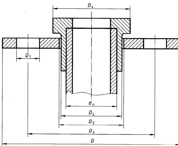
Figure 1 — Emboîture à souder ou à coller
