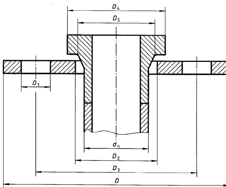
Figure 2 — Systèmes à soudage bout à bout
