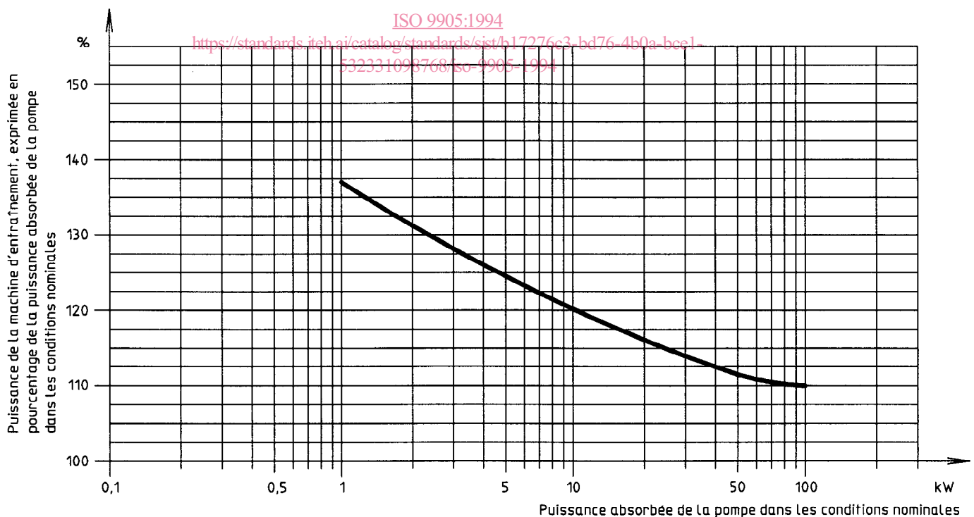
Figure 1 — Puissance de la machine d'entraînement, exprimée en pourcentage de la puissance nominale absorbée de la pompe entre 1 kW et 100 kW
