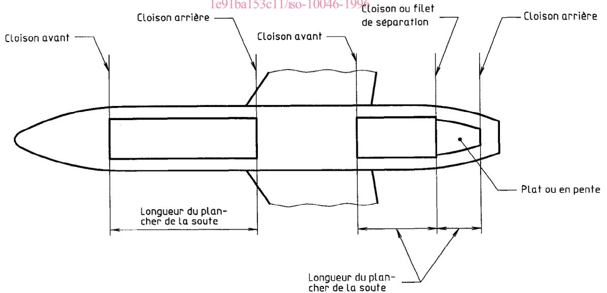
Figure 4 — Longueur utile des soutes de pont inférieur
