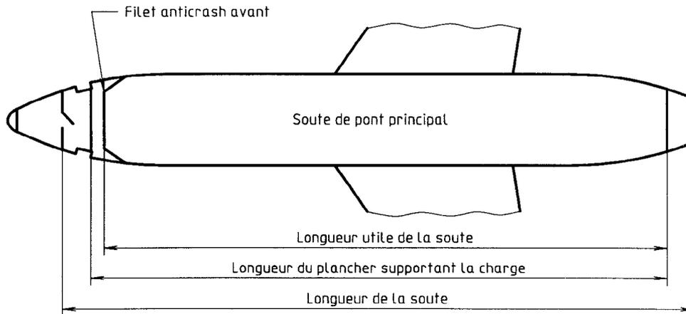
Figure 1 — Longueur utile de la soute de pont principal
