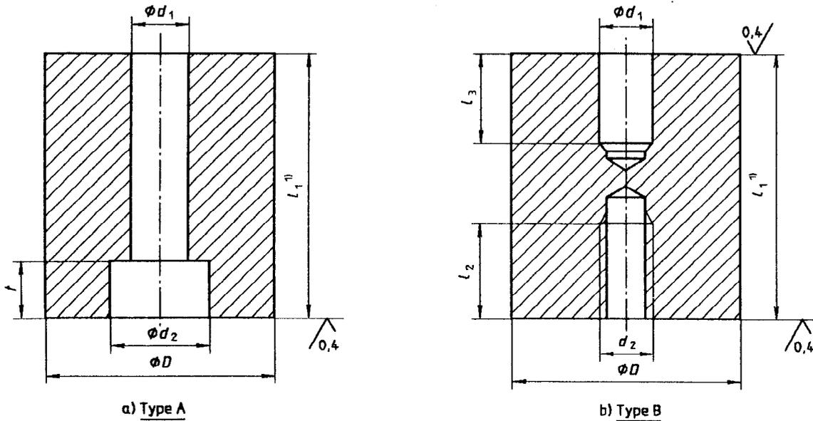
1) Les carcasses d'éjection et les piliers d'entretoisement doivent être rectifiés à la même hauteur lors de leur assemblage dans les moules complets.
