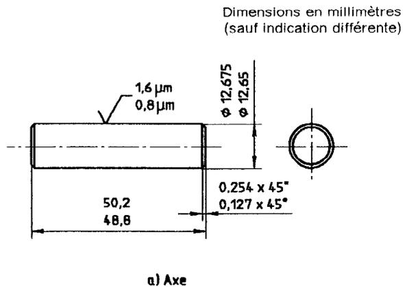
Figure 1 — Support d'éprouvette
