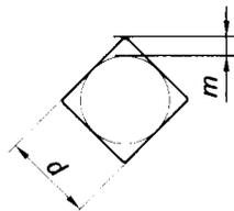
Cas 3 – Plaquettes avec arêtes de planage (voir note de 3.7)
