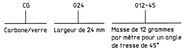
La largeur du ruban, la masse par mètre de longueur du ruban et l'angle de tresse peuvent être déterminés par la méthode prescrite en 7.2.
