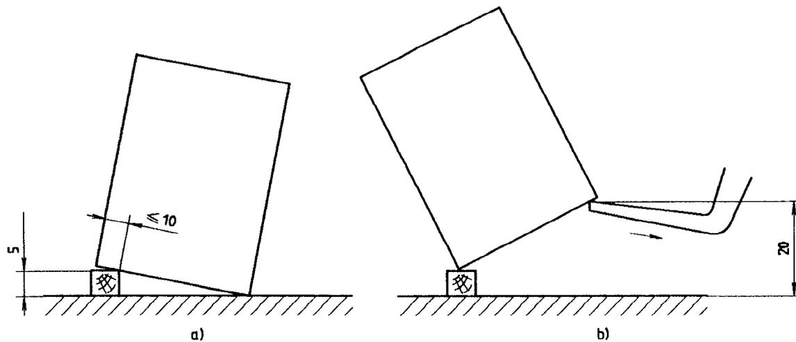
Figure 2 — Essai de chute sur une arête inférieure
