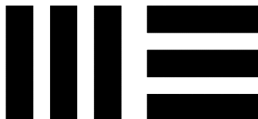
Figure 2 — Mire d'essai pour la vérification du pouvoir séparateur
