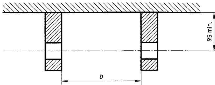
Figure 3 — Dimensions de l'attache de l'attelage pour l'instrument
