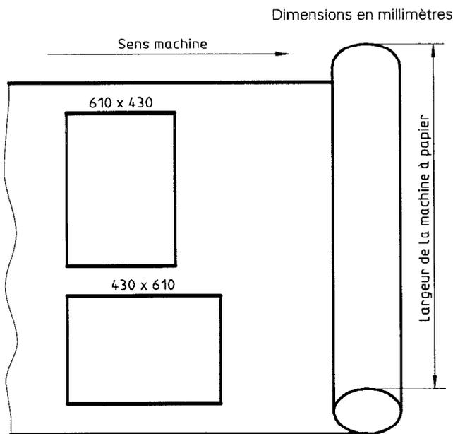
Figure 1 — Désignation du format et du sens de fabrication
