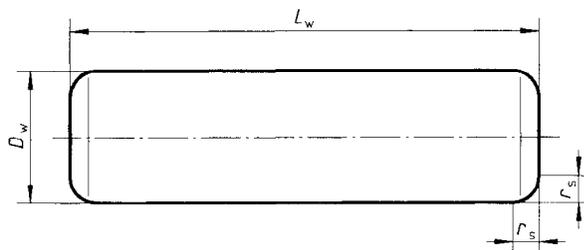
Figure 1 — Aiguille à bouts plats
