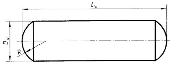
Figure 2 — Aiguille à bouts arrondis
