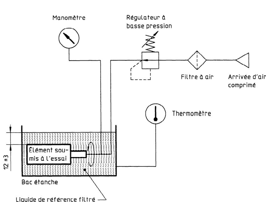
Figure 1 — Banc d'essai à la bulle type
