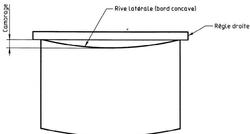
NOTE — Le cambrage est l'écart maximal entre une rive latérale et la ligne droite, le mesurage s'effectuant sur le côté concave, au moyen d'une règle droite.
