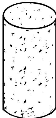
Figure 2 — Bouchon entièrement en aggloméré de liège
