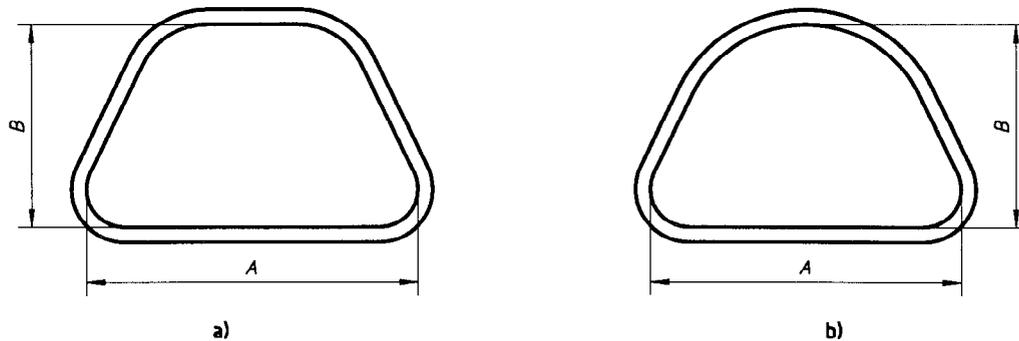
Figure 5 — Boîtes trapézoïdales
