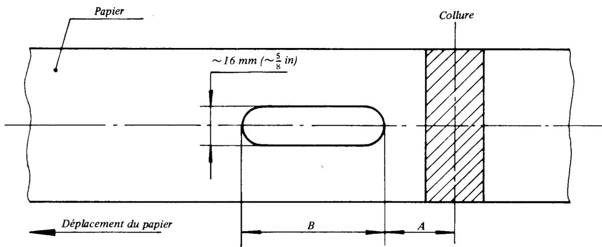
FIGURE – Fente d'indication de collure
