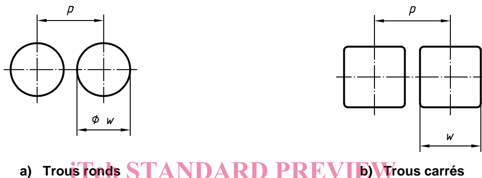
Figure 1 — Disposition des trous ronds et trous carrés dans les tamis de contrôle
