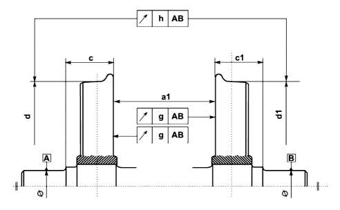
Figure 1 — Wheel parameters
