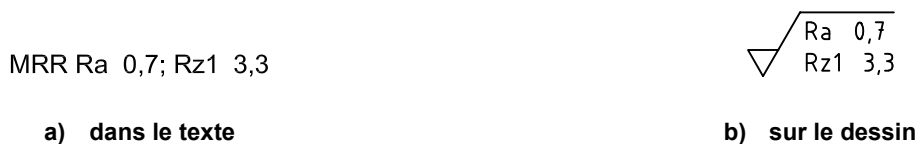
Figure 7 — Indication des paramètres lorsque s'applique la «règle des 16 %» (bande de transmission par défaut)
